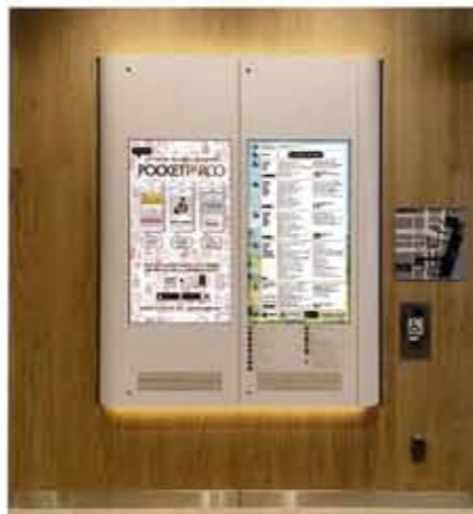
▲ エントランスに設置されたデジタルサイネージ。46インチの液晶ディスプレイ(解像度FHD、輝度700cd/m 2 )2面。
